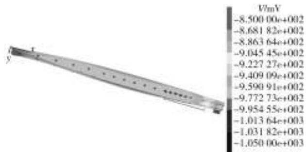
图5 牺牲阳极保护状态船体电位分布
