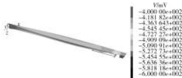
图3 无保护状态船体表面电位分布
