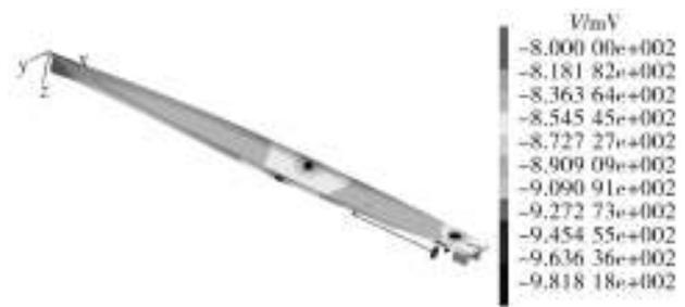
图4 外加电流保护状态船体电位分布
