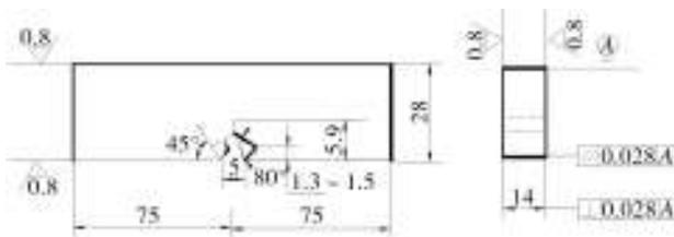
图1 腐蚀疲劳试样尺寸
