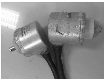
图6 胶接密封后光电编码器外形
