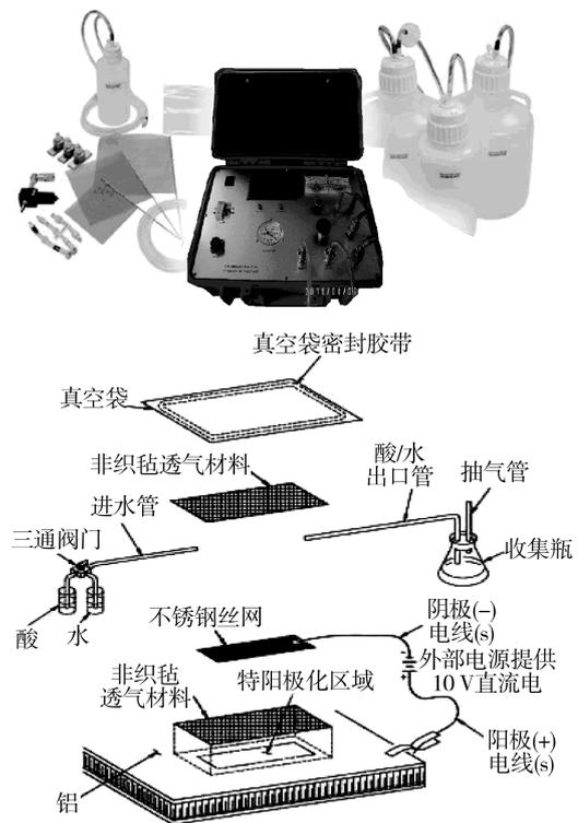
图 1 原位磷酸阳极化的工作原理
