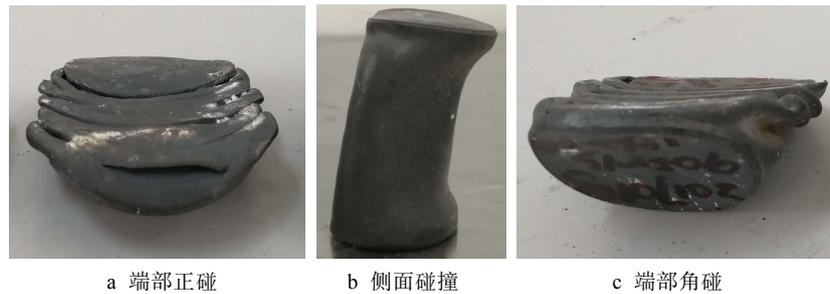
图 7 小试样的最终变形
