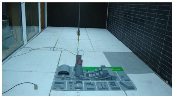
c C 电厂热线测量空腔区湍流度测量 ( $\lambda_L=1:400$ )
