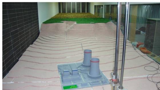
b B 电厂复杂地形冷却塔后湍流度测量 ( $\lambda_L=1:600$ )
