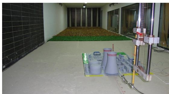
a A 电厂平坦地形冷却塔后湍流度测量 ( $\lambda_L=1:600$ )
