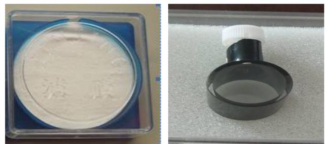
图 6 玻璃纤维萃取滤膜与检测比色皿
