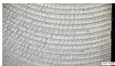
图2 锡铋合金加工表面形貌
