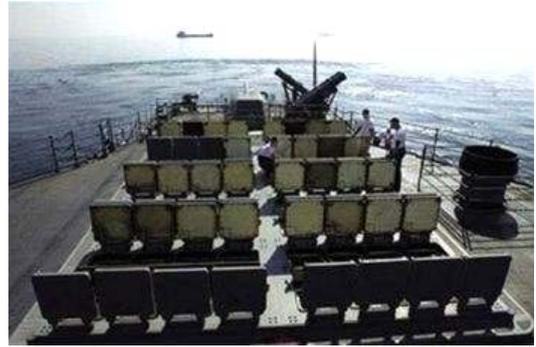
图 3 通用垂直发射装置
