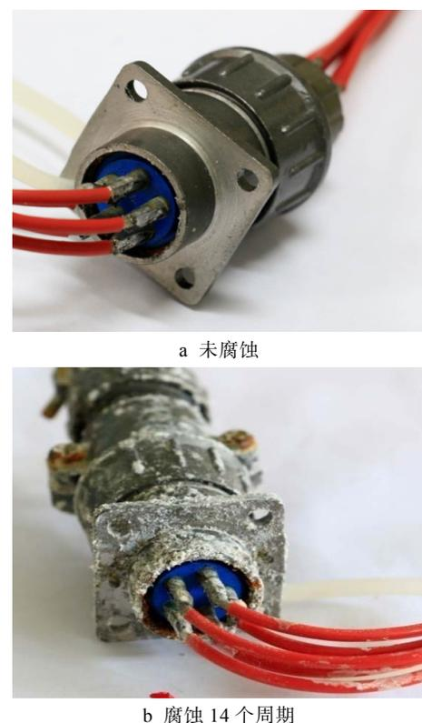
图 2 电连接器母头的宏观形貌（腐蚀 14 个周期）
