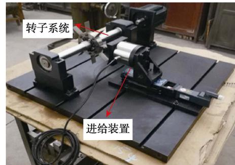
图 8 转子-盘片-机匣碰摩试验器
