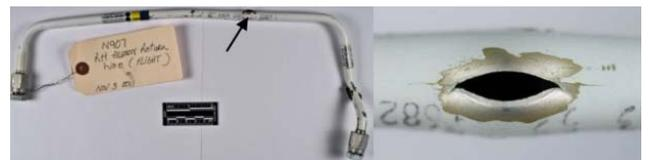
图 2 飞机液压管路爆裂
