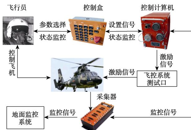
图 3 HES 系统工作原理
