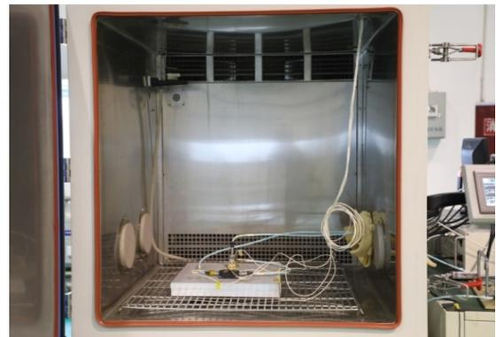
图 7 加速寿命试验场景 2
