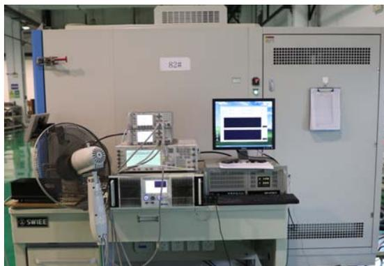
图 6 加速寿命试验场景 1
