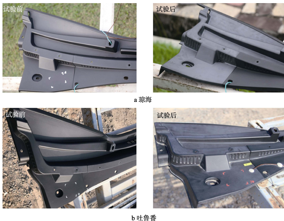
图 1 通风盖板试验前后外观变化
