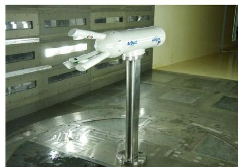
图 6 闭口回流式结冰风洞喷雾测量
