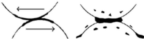
图 2 膜层电阻的形成过程
