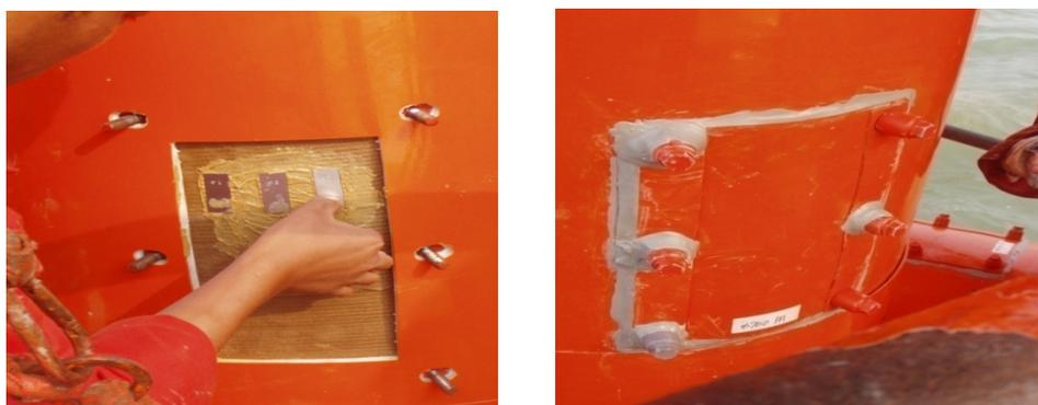
图9 安装保护试片
