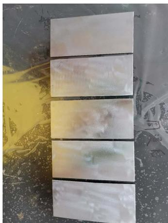
图 6 矿脂防蚀带周浸试验后剥离包覆层后的试板
