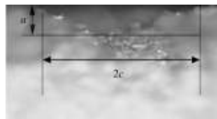
图4 疲劳断面蚀坑形状
