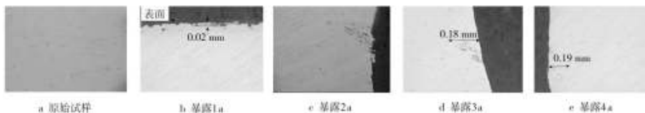
图3 2D12铝合金暴露不同时间的金相显微照片(200×)
