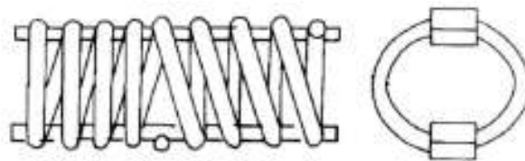
图1 钢丝绳隔振器结构示意图
