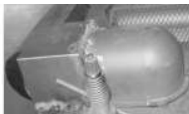
图6 左排风口延长30 mm Fig. 6 Left exhaust hole prolong 30 mm
