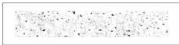
图5 当量腐蚀19 a的试件表面腐蚀二值化图像
