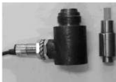
图4 车速传感器连接装置
