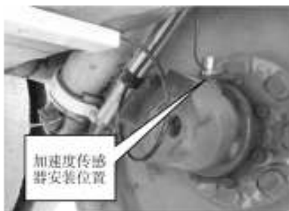
图3 加速度传感器的安装
