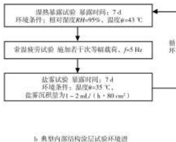
图 2 典型结构涂层加速试验环境谱
