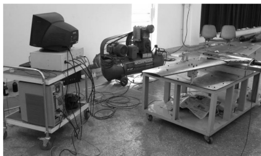
图4 折叠翼展开后状态及部分试验设备
