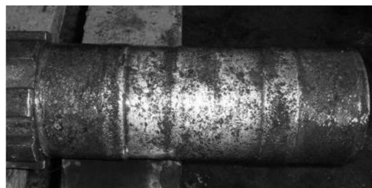
图3 前起落架轮轴磨损腐蚀状况
