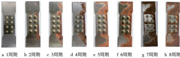
图 10 涂 WD 40 试验件 8 个周期后腐蚀情况
