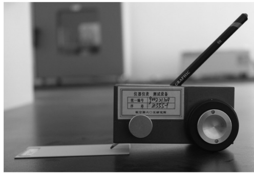
图3 测量铅笔硬度 Fig.3 Pencil hardness test
