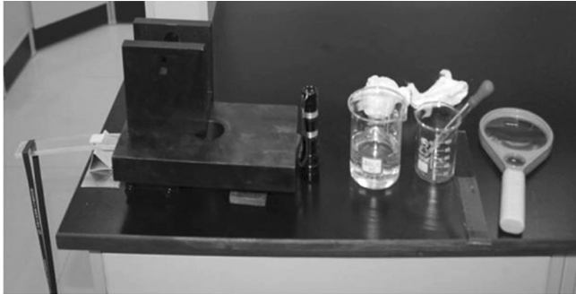
图6 清洗剂对有机玻璃影响试验过程
