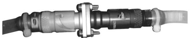
图6 系统流阻短接测试方式
