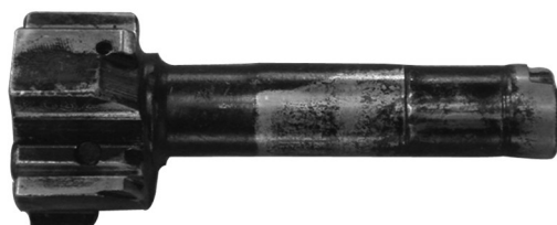
图2 部队服役某型自动步枪机头磨白情况
