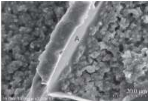
图4 SiO 2 气凝胶颗粒与砂浆粘接界面
