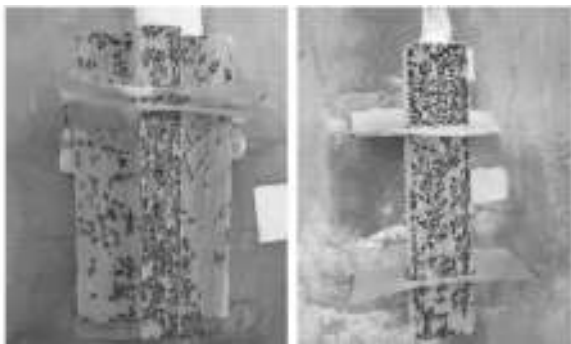
图9 试验后 A 2 , B 2 阳极的表面形貌
