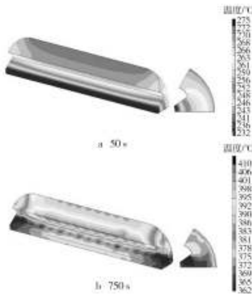
图5 快速烤燃时推进剂温度分布
