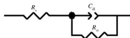
图 4 拟合 EIS 谱图的等效电路
