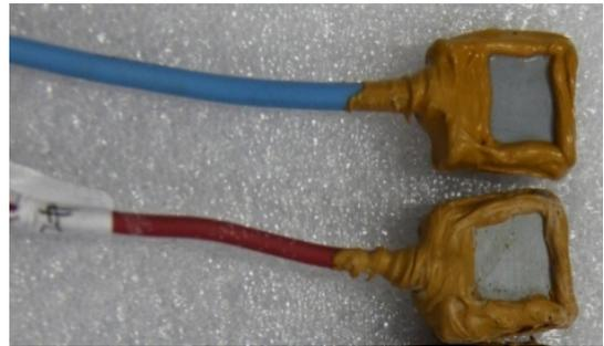
图2 电化学阻抗试验涂层试样
