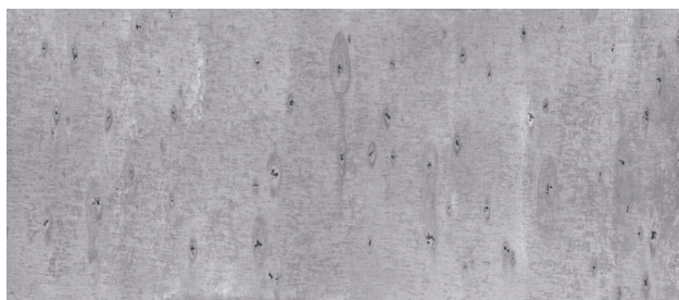
图 1 LY12CZ 试件点蚀萌生扫描电镜微观图片
