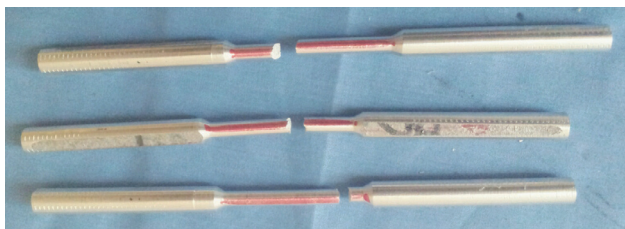
图5 典型试样拉伸断裂后形态
