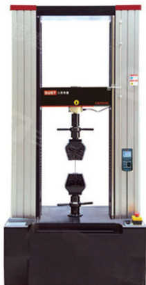
图4 单轴拉伸实验测试装置
