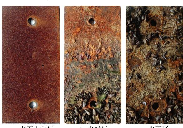
图 4 Q235B 材料 1 a 试验后的腐蚀形貌
