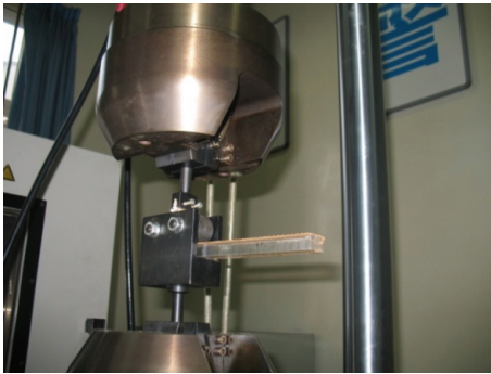
图 2 剥离试验试样支持状态
