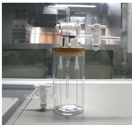
图3 铜测试片电解还原电解池
