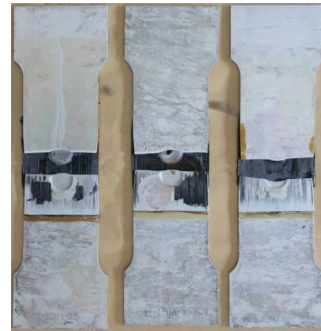
左：常温固化材料 中：J-150 胶粘剂 右：环氧树脂预浸料 图 11 采用不同填充材料修理后的试件失效情况
