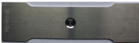
图 1 含未穿透腐蚀坑的损伤结构件
