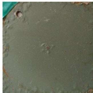
图 6 九个试验周期之后军绿有机涂层宏观形貌
