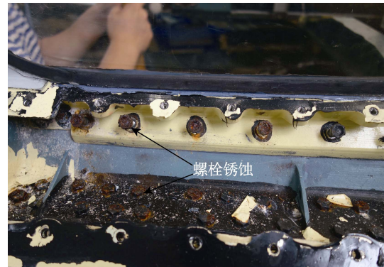
图 10 风挡骨架及压板安装螺栓锈蚀
