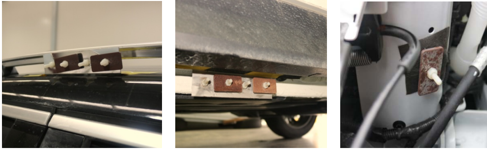
图2 车顶、车底、发动机舱内标准钢板安装
