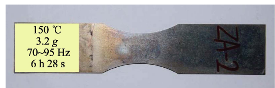
图 9 高温随机振动试验后试验件破坏的结果
