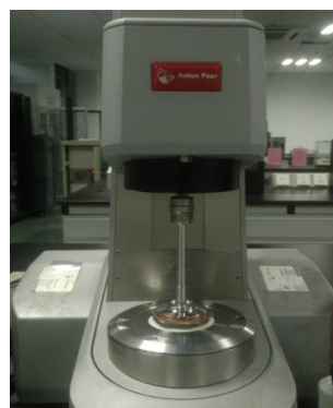
图2 MCR 301型流变仪
