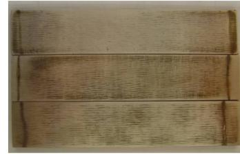
图 8 钨合金镀层试样 HIC 试验后形貌
