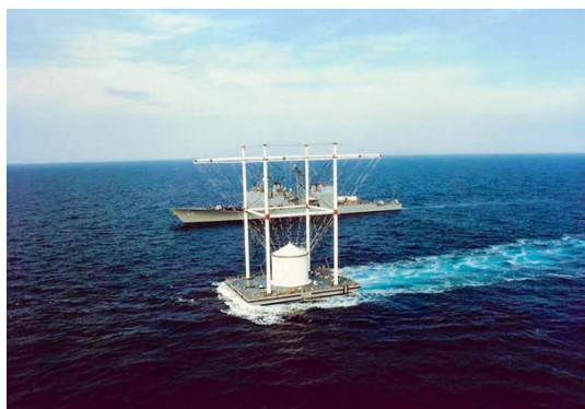
图7 美国海军在切萨皮克湾进行全舰 EMP 试验
