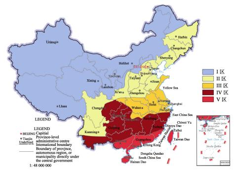
图 3 基于航空金属材料腐蚀的我国大气环境分区结果
